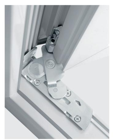
Mit nur zwei zusätzlichen Bauteilen – Flügellagerschiene und Adapterplatte – lässt sich die Tragkraft von 100 kg auf bis zu 150 kg erhöhen.
